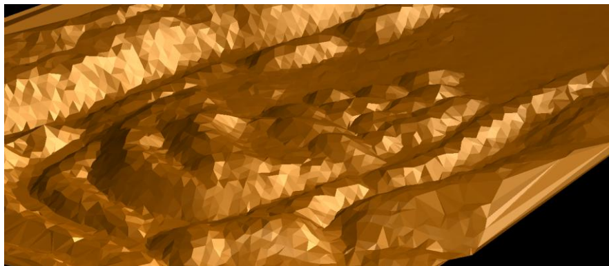
Gambar 3. Hasil digital teraim model pengukuran dengan TLS pada surpac.
