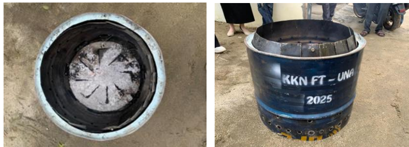
Gambar 1. pengujian tungku pembakaran minim asap
