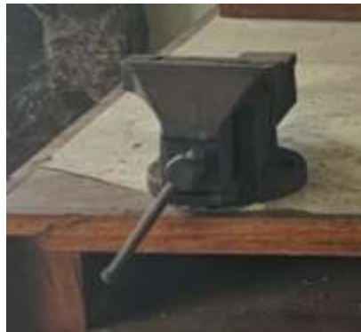
Gambar 6. Contoh Ragum untuk Pemegangan-Penjepitan Benda Kerja
