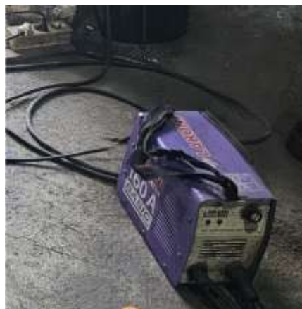
Gambar 4. Contoh Peralatan untuk pengerjaan penyambungan pegangan kunci bentuk Y dilakukan dengan pengelasan listrik
