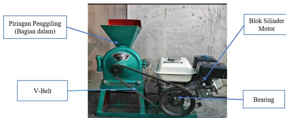
Gambar 1. Posisi dan Nama-nama Komponen Penggiling Tepung Beras.
