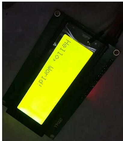
**Gambar 4.1 Pengujian LCD I2C**
