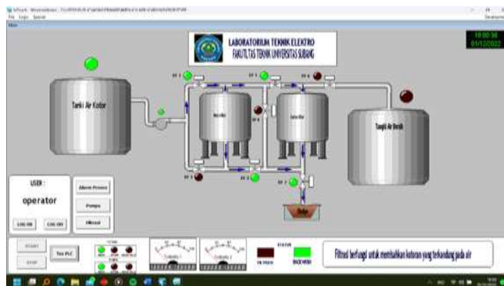
Gambar 13. Jendela Utama Sistem SCADA
