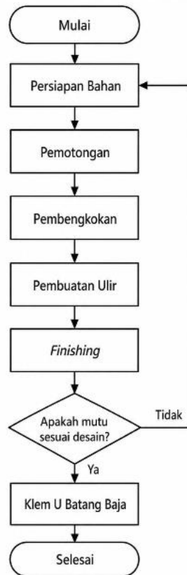
Gambar 2. Diagram Alir Manufaktur Klem U Batang Baja.
