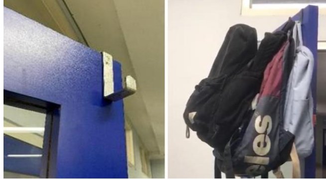
Gambar 5. Contoh pemasangan dan pembebanan penggantungan pakaian bentuk S dengan 3 tas ransel beban sekitar > 6 kg mampu digantungkan tanpa deformasi.
