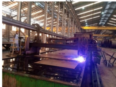
Gambar 1. Pemotongan Plat Besi menggunakan CNC Plasma
