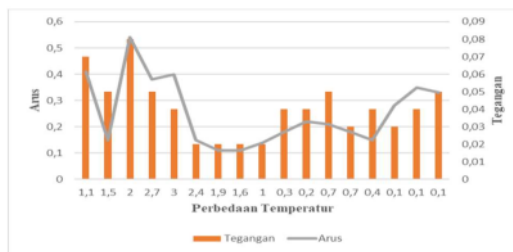
Gambar 2-7 Pengaruh perbedaan temperatur terhadap 2 tegangan dan arus pada rangkaian seri
