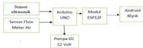
Gambar 12 Block diagram perancangan alat Sumber: Dokumen Pribadi
