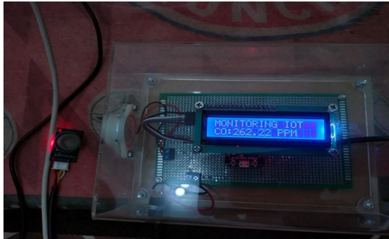
Gambar 4. Penyajian data pada LCD 16x2
