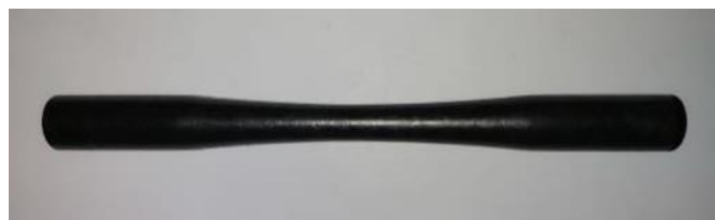
Gambar 3. Spesimen Uji Lelah dari Bahan ABS Hasil Cetak Injeksi Bentuk dan dimensi spesimen uji lelah standar sebagaimana Gambar 4.
