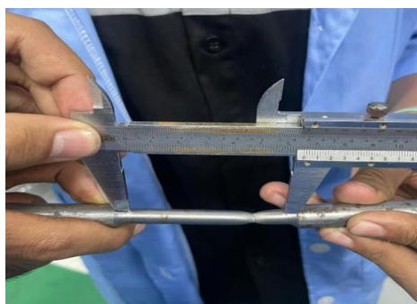
Gambar 5. Pengukuran Jarak Gauge Length , L_1 Diukur dengan Mistar Sorong Setelah Spesimen Putus dan Ditangkap Kembali secara Tepat Posisinya.
