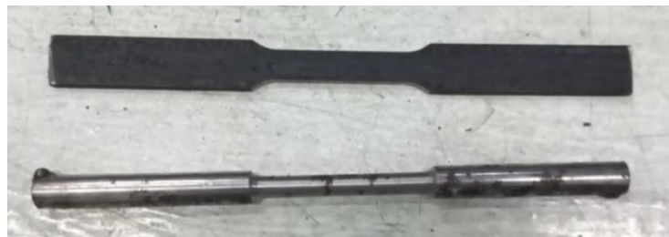
Gambar 1. Spesimen Uji Tarik Bentuk Penampang Silindris dan Penampang Persegi Empat.
