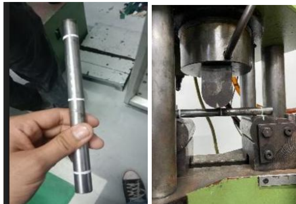
Gambar 1. Spesimen Baja Karbon Rendah Setelah Ditandai Jarak Tumpuannya dan Siap Diuji Lentur pada Mesin Uji Lentur Tarno Grocki.
