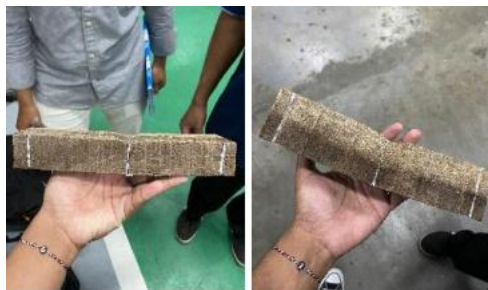
Gambar 3. Spesimen Kayu Usuk Posisi Tidur Sebelum dan Sesudah Diuji Lentur pada Mesin Uji Lentur Tarno Grocki.
