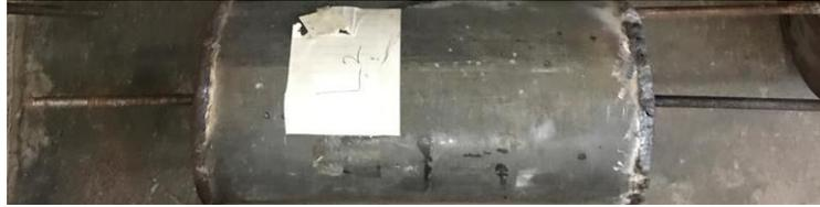
**Gambar 3. Spesimen uji lekat angkur variasi L bolt**
