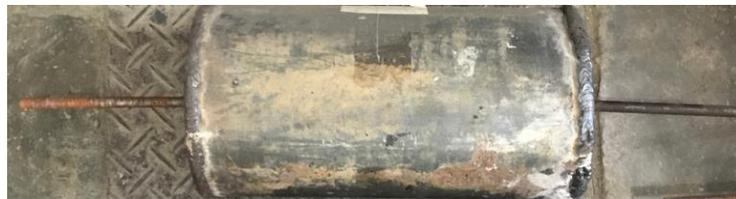
**Gambar 5. Spesimen uji lekat angkur variasi J bolt**
