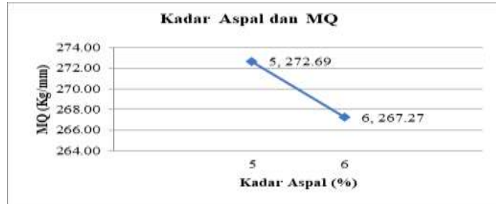
Gambar 6 Grafik hubungan antara kadar aspal AC-BC dengan MQ ( Marshall Quotient ) (Kg/mm) pada abu bata dengan kadar 6%. (Sumber: Hasil Pengujian Laboratorium Tahun 2023)
