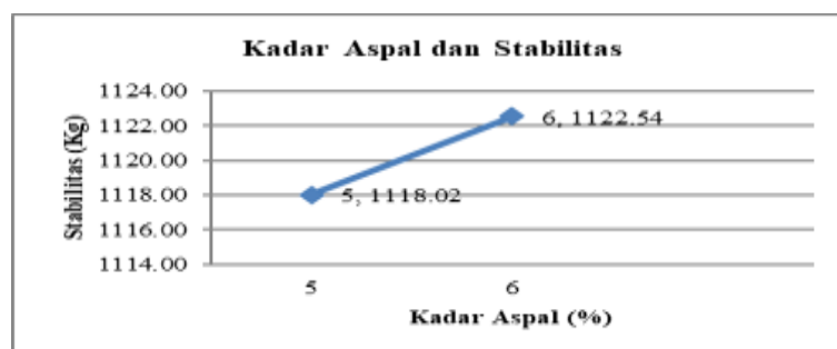
Gambar 1 Grafik hubungan antara kadar aspal AC-BC dengan Stabilitas (kg) pada abu bata dengan kadar 6%. (Sumber: Hasil Pengujian Laboratorium Tahun 2023)
