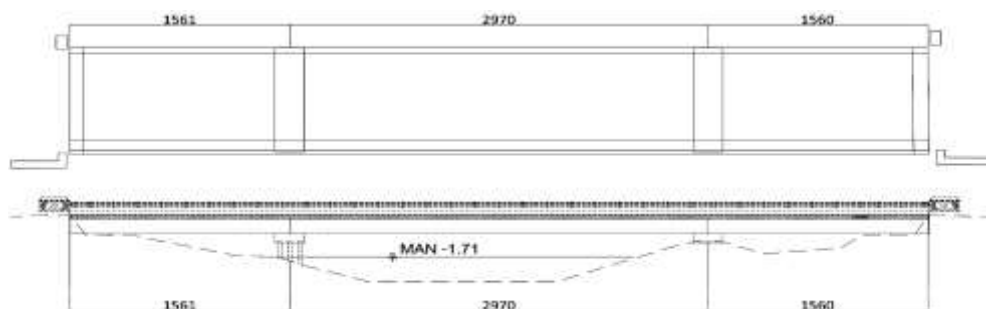
Gambar 2.2 Denah dan Tampang Samping Jembatan Maribaya A
