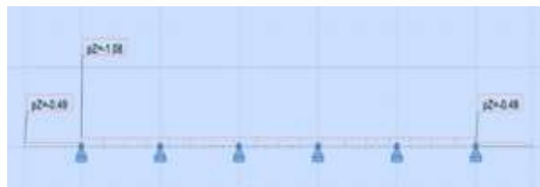
Gambar 13. Perletakan beban akibat beban mati tambahan (MA)
