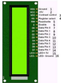
Gambar 8. Pin LCD 16 x 2 ( A. Faudin)
