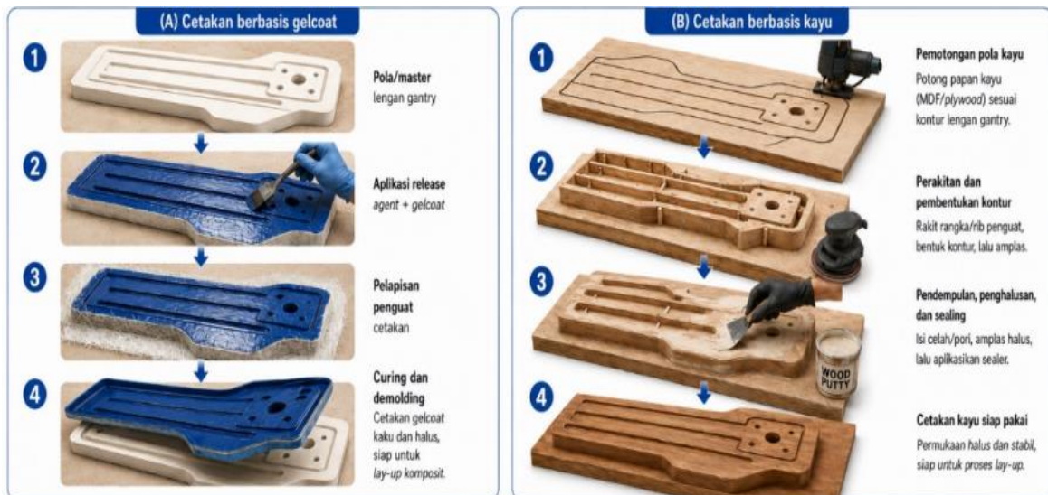
Gambar 3. Ilustrasi Pembuatan Cetakan Lengan Gantry CNC Router Komposit Epoxy-Pipa Aluminium dari bahan A) Gelcoat dan B) Kayu.
