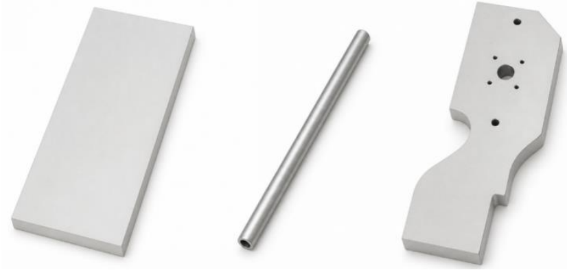
Gambar 1. Urutan dalam Pembuatan Produk Lengan Gantry , (a) Cetakan pelat komposit, (b) Pipa Aluminium, (c) Lengan Gantry CNC Router.
