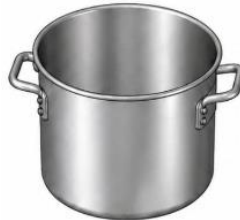
Gambar 1. Pandangan 3 Dimensi/Isometris Panci Masak Diameter 200 mm, Tinggi 150 mm untuk Volume 4 Liter.
