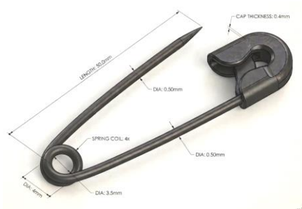
Gambar 1. Isometris Produk Peniti Kain Ukuran Panjang 50 mm, Diameter Kawat 0,5 mm.
