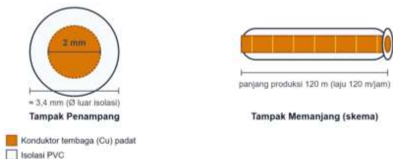
Gambar 1. Kabel Tunggal Tembaga Tipe NYA Diameter 2 mm, Tebal Isolator PVC 0,7 mm
