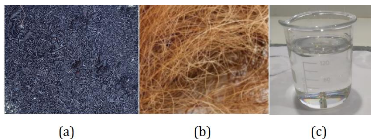
Gambar 1. Bahan Eksperimen: (a) Serbuk Arang Kelapa, (b) Serat Kelapa, dan (c) Resin Polyester.
