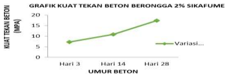
Gambar 4. Grafik pengujian kuat tekan beton Sika Fume variasi 2%
