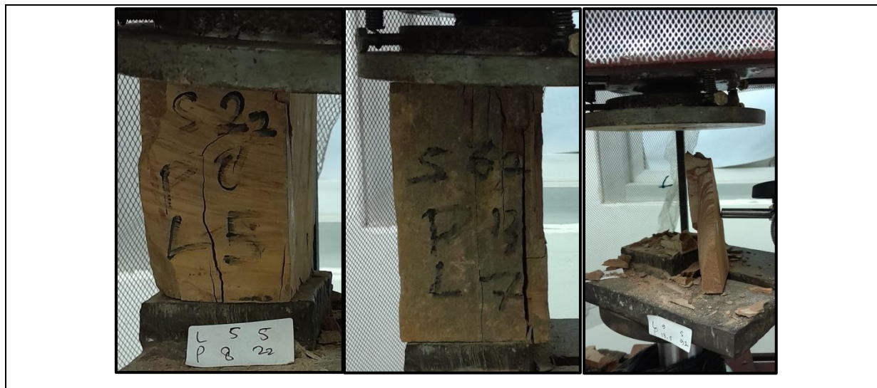
Gambar 9 Hasil Pecah Contoh Batu Uji
