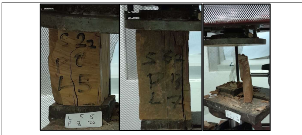
Gambar 9 Hasil Pecah Contoh Batu Uji
