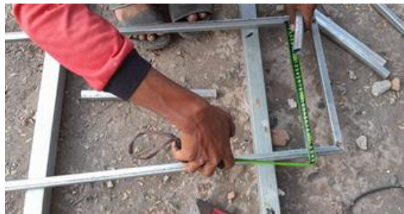
Gambar 3 Proses Pengukuran & Pemotongan Besi Hollow
