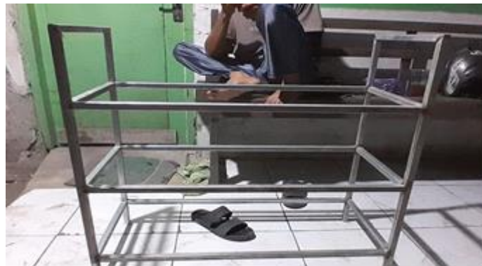
Gambar 8 Kerangka Utuh Rak dari Pengelasan Besi Hollow
