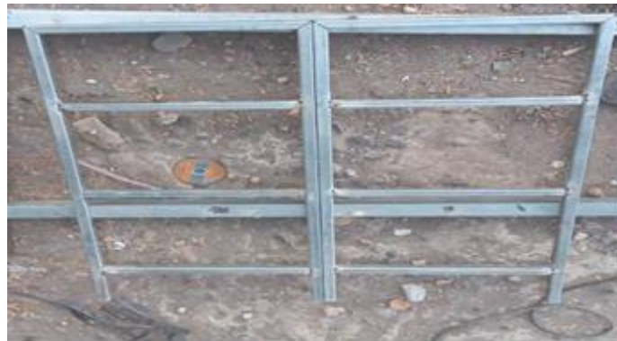
Gambar 7 Kerangka Rak dari Pengelasan Besi Hollow
