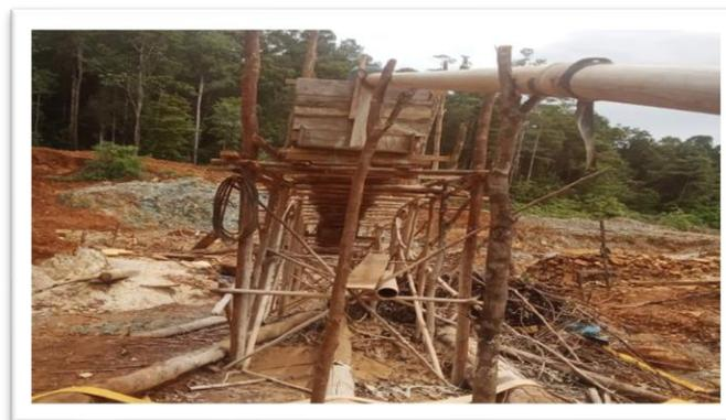
**Gambar 2. kotak sluice box**
