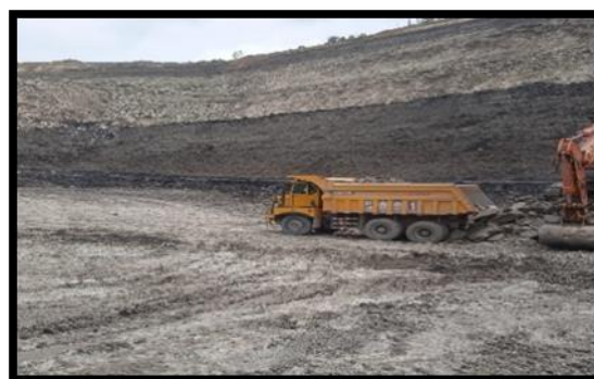
Gambar 5. Segmen 0-1 nilai rolling resistance 16% Kondisi aktual sebelum perbaikan
