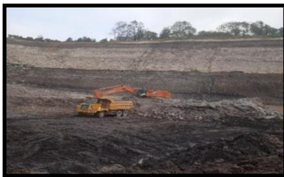
Gambar 6. Segmen 0-1 nilai rolling resistance 12% Kondisi aktual setelah perbaikan perbaikan
