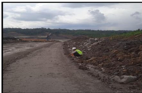
Gambar 7. Pengambilan sampel lebar jalan lurus aktual tiap segmen jalan
