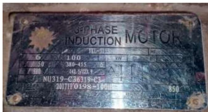
**Gambar 4.** Name Plate Motor Induksi
