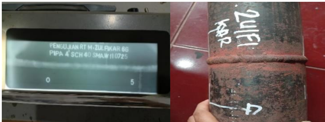
Gambar 1. Film untuk 0-5 No Defect .
