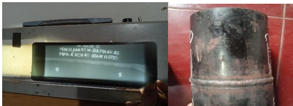
Gambar 4. Film untuk 0-5, No Defect .
