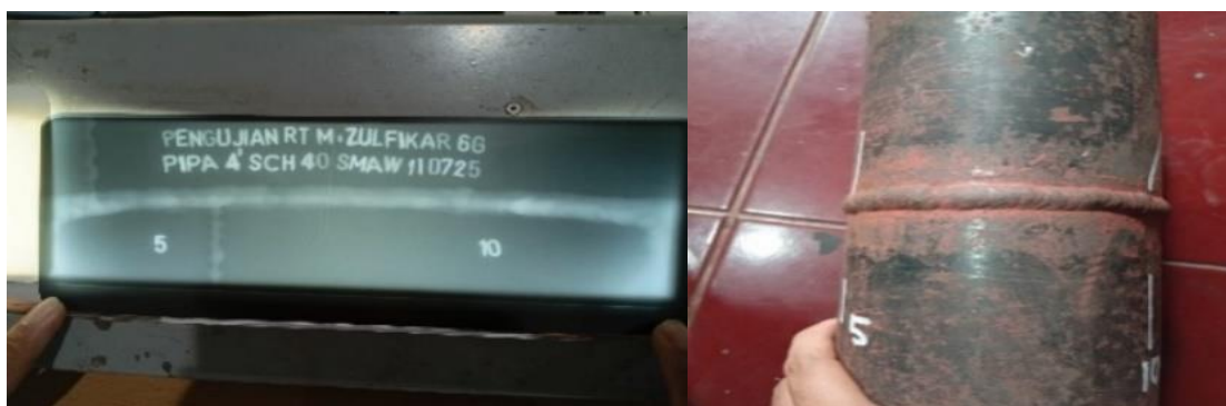
Gambar 2. Film untuk 5-10, terdapat cacat las Porosity .
