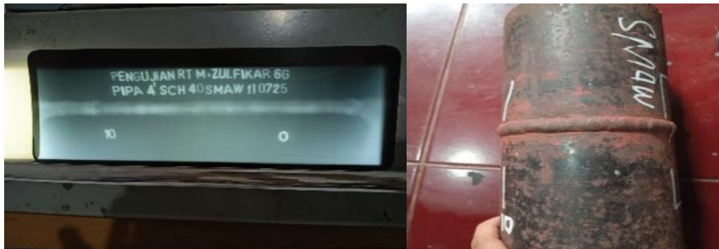
Gambar 3. Film untuk 10-0, No Defect .
