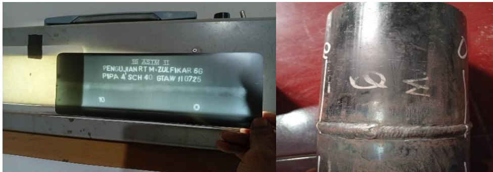
Gambar 6. Film untuk 10-0, No Defect
