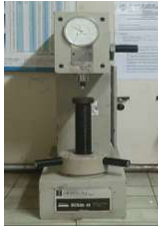
Gambar 9. Mesin pengujian kekerasan Hoytom Minor 69 .
