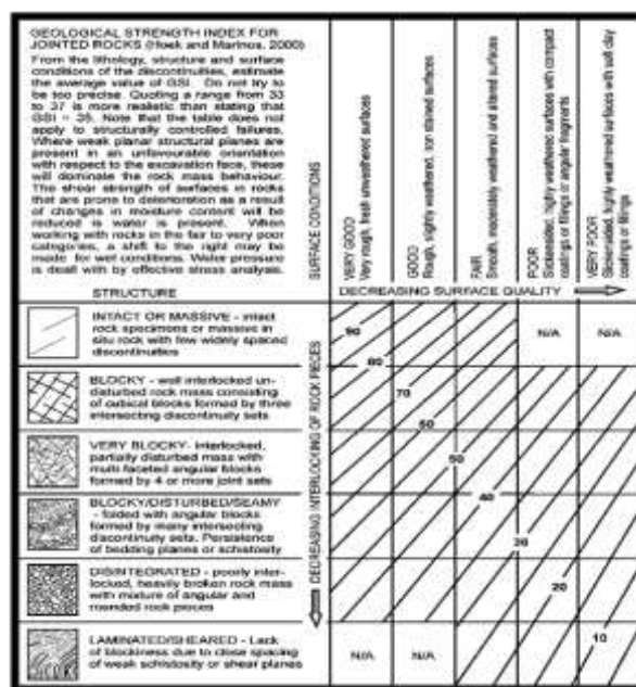
Gambar 1. Parameter Geological Strength Index Untuk Massa Batuan Umum.
