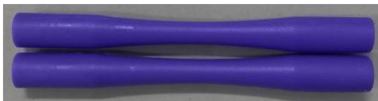
Gambar 4. Contoh Spesimen Plastik PP Daur Ulang 50%
