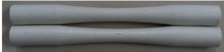
Gambar 6. Contoh Spesimen Plastik HIPS Daur Ulang 50% Bentuk dan dimensi spesimen uji lelah standar sebagaimana Gambar 7.
