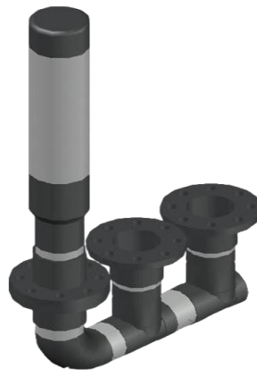
Gambar 2. Desain Pompa Hidram.
