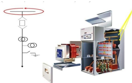
Gambar 1. Ilustrasi Penyulang di Gardu Induk.
