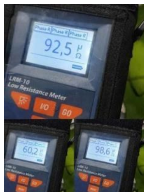
Gambar 2. Hasil Pengujian Tahanan Kontak Penyulang Algojo.
