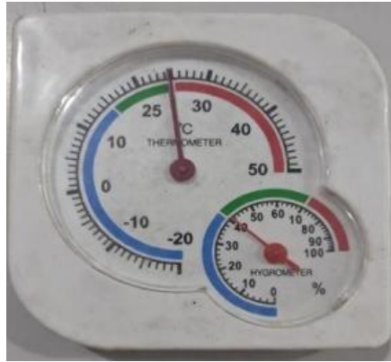
Gambar 6. Hasil Ukur Kondisi Suhu dan Kelembaban.
