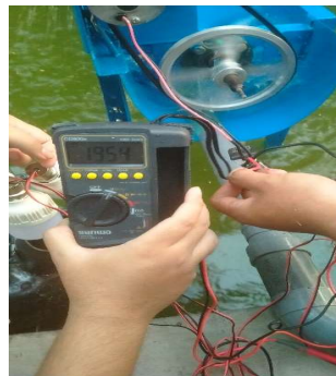
Gambar 10 Pengukuran tegangan tanpa beban menggunakan Multimeter.
