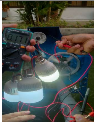
Gambar 9 Pengukuran arus listrik menggunakan Multimeter.
