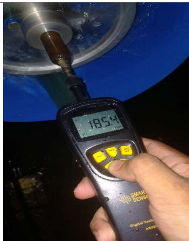
Gambar 15 Pengukuran RPM turbin menggunakan Tachometer .
