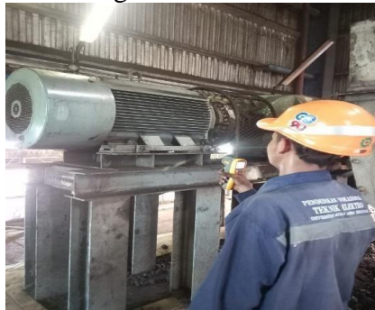
Gambar 19. Mengecek Suhu Motor
