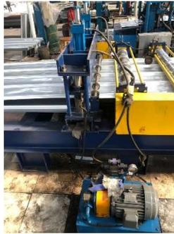
**Gambar 3.** Tahap Akhir Pemotongan Atap
