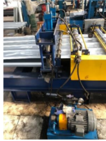
Gambar 3. Tahap Akhir Pematongan Atap (Dokumentasi Pribadi)
