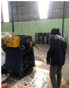
Gambar 2. Proses Pembentukan Atap (Dokumentasi Pribadi)
