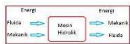
Gambar 1. Arah perubahan energi pada mesin hidrolik
