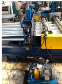
Gambar 4. Implementasi Mesin spandek (Dokumentasi Pribadi)
