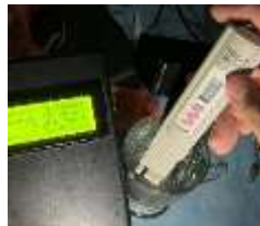
Gambar 25 Pengujian Presisi Sensor TDS
