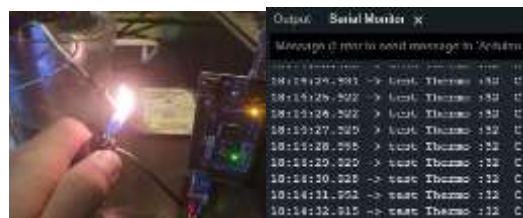
Gambar 18 Pengujian Sensor Suhu Sumber : Dokumen Pribadi (2024)
