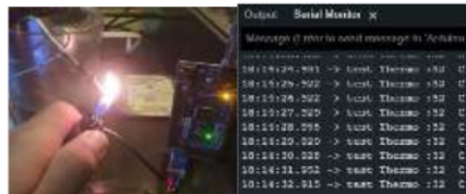
Gambar 18 Pengujian Sensor Suhu Sumber : Dokumen Pribadi (2024)
