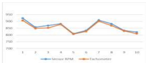
Gambar 28 Grafik sensor RPM dengan tachometer Sumber: Dokumentasi pribadi (2024)
