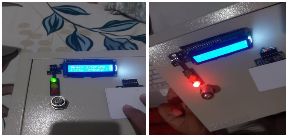
Gambar 4. 2 Pengujian Sensor RFID READER.
