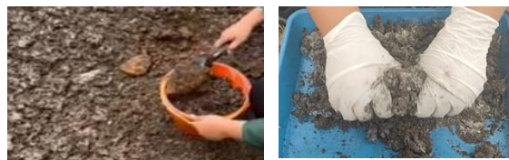
Gambar 1. Pengambilan Lumpur IPAL dan Pencampuran Bahan
