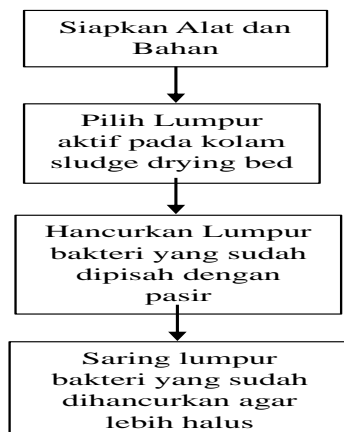
Gambar 1 Flowchart pembuatan Pupuk Organik.
