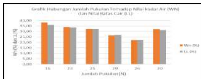
Gambar 7 Grafik Hubungan Jumlah Pukulan Terhadap Nilai Kadar Air (W n ) dan Nilai Batas Cair (LL)
