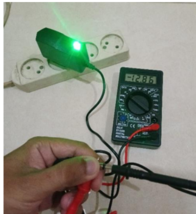
Gambar 12. Power Supply (Adaptor) diukur dengan avometer serta indikator lampu menyala
