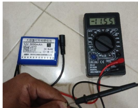
Gambar 12. Baterai Portable dapat melihat tegangan yang keluar dengan Avometer
