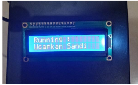
Gambar 8. Display LCD 16x2 dapat menampilkan kondisi system
