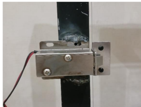
Gambar 11. Solenoid Door Lock berfungsi dengan baik (terjadi pergerakan)
